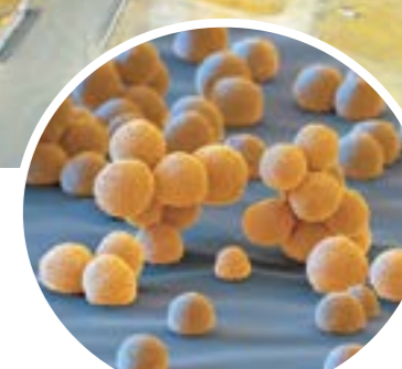
Leistungsstarke Kathodenmaterialien in der Vergrößerung 1400:1. Sie sind wesentlicher Bestandteil von Lithium-Ionen-Batterien für Elektrofahrzeuge. Foto: BASF
