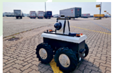
Ein Roboterfahrzeug soll zukünftig die Trailer im Lübecker Hafen erkennen und lokalisieren.
